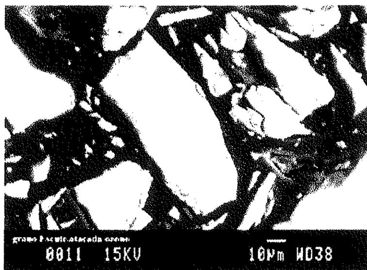
Fig.128. Granos de skutterudita atacados con  $O_2/O_3/H_2SO_4$
