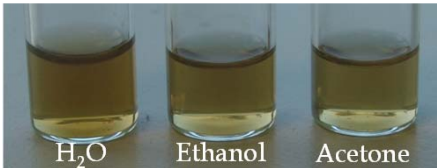
Figura 3. Soluciones coloidales de nanopartículas compuestas en diferentes solventes polares.
