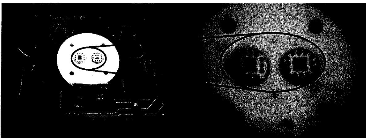
*Cámara con preconcentrador y sensor integrados en sustratos de silicio
